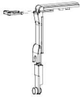
köşe hareket aktarıcı corner transmission for window
